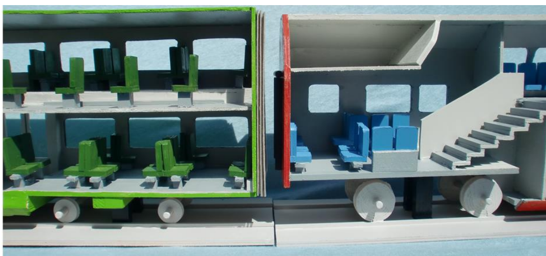
Bild 4: Vergleich der Wagenenden eines konventionellen Doppelstockwagens (rechts) und eines innovativen Doppelstockwagens mit einem Fahrwerk mit kleinen Rädern
